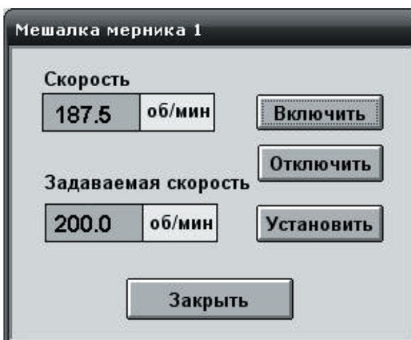
Рис. 5. Малоформатное окно управления мешалки мерника 1
