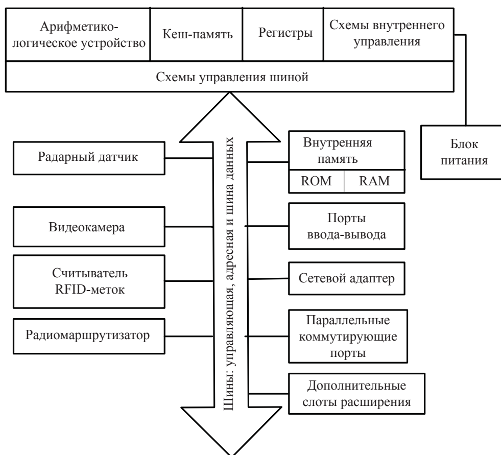
Рис. 5. Архитектура основного аппаратного модуля идентификации
