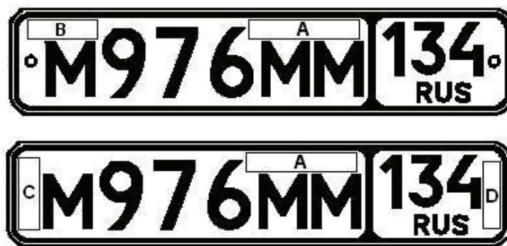
Рис. 1. Зоны размещения RFID-метки на ГРЗ типа 1 с трехзначным кодом региона регистрации (габаритные размеры 520×112 мм): зона А — 125×24 мм; зона В — 80×24 мм; зона С — 90×26 мм; зона D — 90×22 мм
