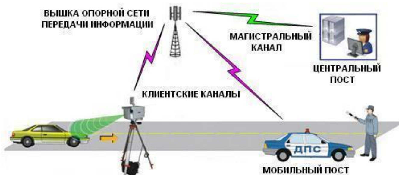
Рис. 4. Схема работы мобильного модуля идентификации
