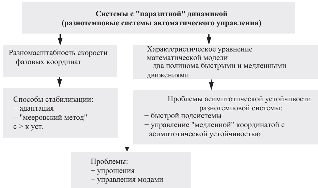
Рис. 3. Структура управления системами с “паразитной” динамикой
