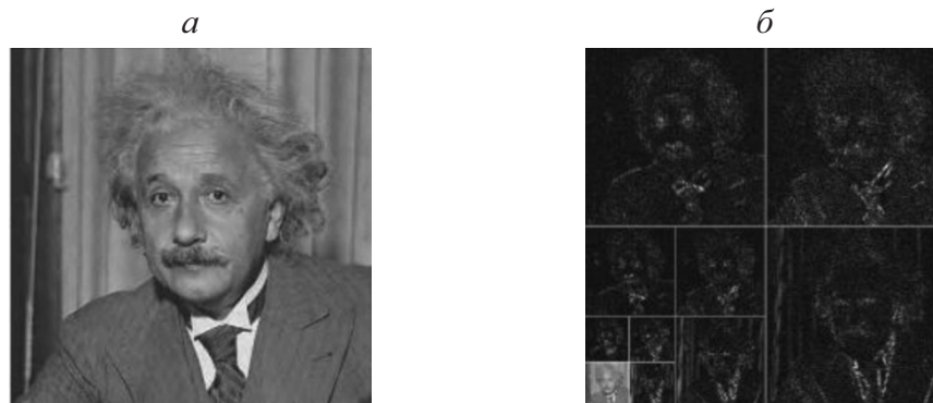
Рис. 2. Алгоритм сжатия изображения на основе вейвлет-преобразования: а – исходное изображение; б – третий шаг дискретного вейвлет-преобразования исходного изображения
