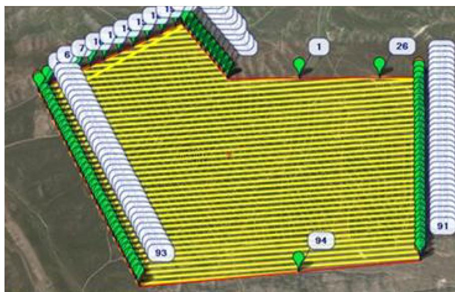
Рис. 1. Результат планирования полета в программе Mission Planner
