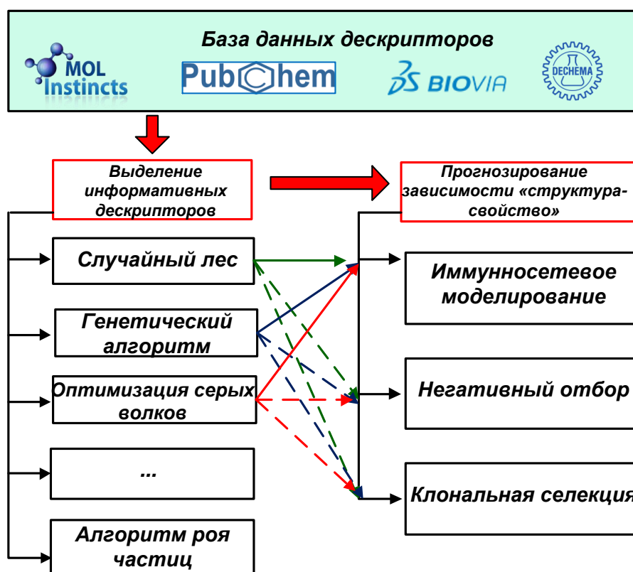
Рис. 1. Технология прогнозирования QSAR на основе подходов AIS
